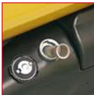
Filtro para llenado del depósito de gasoil
