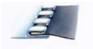
Detalle engatillado tipo LOC-4
