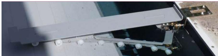
Estos soportes de aluminio lacado gris, están especialmente diseñados para piscinas cuyo nivel del agua está a 50 mm desde la cuenca nivelado (piscinas con skimmer espejo), y se colocan a cada metro en el ancho de la piscina. Permiten eliminar la viga, y apoyar la tapa y el peso de un hombre de 80 kg.
