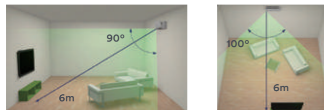
Cobertura del dispositivo sensor de movimiento
