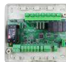
CENTRAL DE CONTROL DE EQUIPOS DE PRODUCCIÓN
