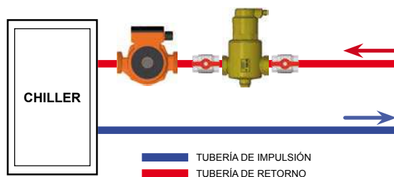
CORRECTA INSTALACION DEL DESAIREADOR EN LAS INSTALACIONES GENÉRICAS
