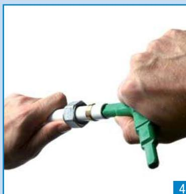
Introduzca de nuevo el calibrador en el extremo del tubo, por la galga adecuada, e imprímale el mismo movimiento de rotación, ejerciendo presión al mismo tiempo para abocardar el extremo; el chaflán que se encuentra al final de la galga del calibrador debe realizar el abocardamiento.
