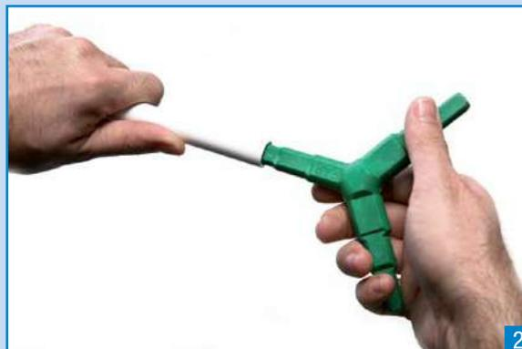
Introduzca el calibrador en el extremo del tubo, e imprímale un movimiento de rotación, para devolver la redondez a la sección del tubo (seleccione en el calibrador la galga adecuada al tamaño del tubo; viene marcado sobre cada galga).
