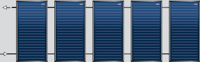
**TOPSON F3-1, F3-1Q Y CFK-1 Máximo 10 captadores a conectar A MANO DISTINTA**
