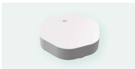
Sensor de fugas de agua. Dos almohadillas sensoras debajo del cuerpo se activan cuando hay agua entre las dos almohadillas. Al detectar el agua, el sensor notifica el evento al controlador (y BEMS).
