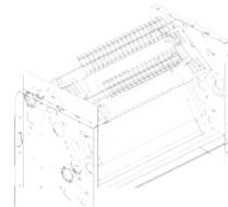
Baterías de calefacción por resistencias eléctricas. Incluye termostato de seguridad (230-i)
