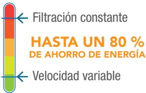
El funcionamiento de una bomba a velocidad variable al 50 % durante 24 horas permite ahorrar energía en cerca de un 80 % frente a una bomba todo o nada durante 8 horas.
